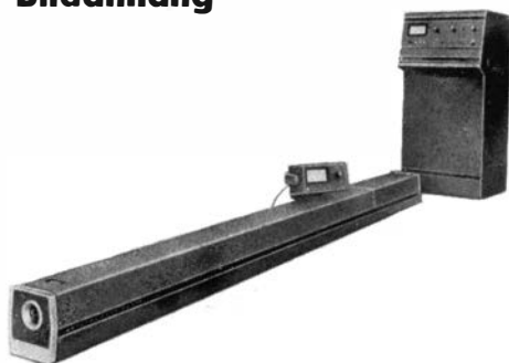
Bild 1. Spectra Physics Modell 170 Dauerstrich- Argon-Ionen-Gas-Laser, mit 15 Watt Leistung
