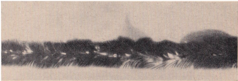
Abb. 46. Gammaaufnahme einer defekten Schweißnaht (durchleuchtet mit Gammastrahlen des Europiums 154)
