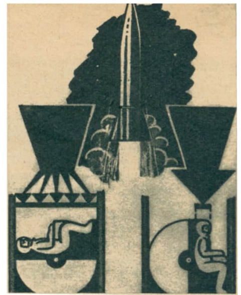
Die Abbildung veranschaulicht, weshalb der Raumpilot beim Start den Beschleunigungsdruck liegend (links) besser verträgt als sitzend (rechts).
