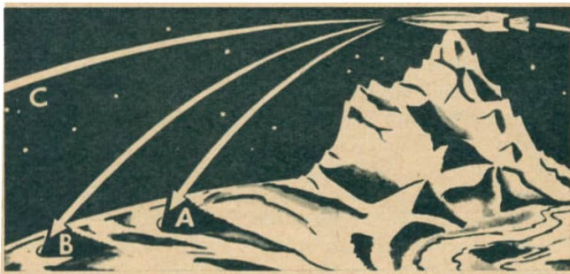
A, B – der Flugkörper beschreibt eine Wurfparabel, C – die erste astronautische Geschwindigkeit ist erreicht, der Flugkörper fällt nicht auf die Erde zurück.
