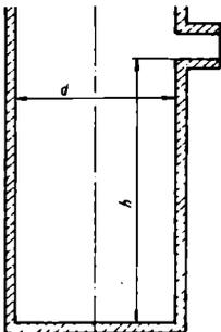
Das Überlaufvolumen  $V_0$  bei  $20^\circ\text{C}$  läßt sich aus dem Überlaufvolumen  $V_{\bar{u}}$  bei  $70^\circ\text{C}$  berechnen, da die Masse  $m_1$  des Wassers bei jeder Temperatur gleich groß ist. Es gilt demzufolge
