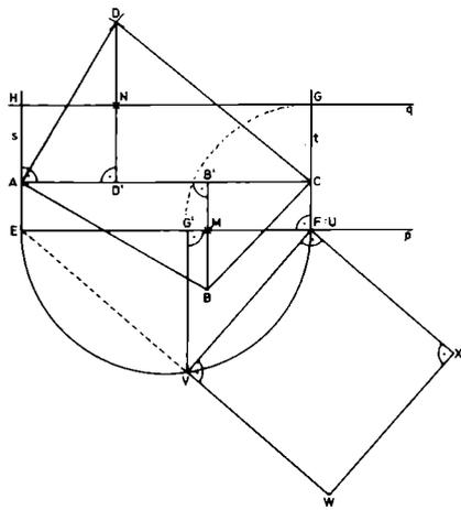
(1) Man konstruiert die Parallelen  $p$  bzw.  $q$  durch die Mittelpunkte  $M$  bzw.  $N$  von  $BB'$  bzw.  $DD'$  zu  $AC$ .
