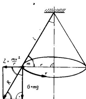
Beide auf  $m$  wirkenden Kräfte lassen sich nach dem Satz vom Parallelogramm der Kräfte durch eine einzige resultierende Kraft  $R$  ersetzen.
