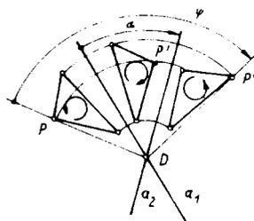
Bild 1d: Schubspiegelung
