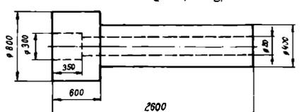
▲10/12▲ Für den Transport von Rohrbündelwärmeüberträgern (RWU) mittels Kran sind an ihnen Tragösen angebracht. Der Abstand der Tragösen betrage 4000 mm. Der Winkel  $\alpha$  zwischen den Seilen darf höchstens  $120^\circ$  betragen.
