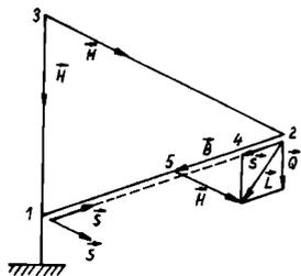
Die Kräfte  $H$  und  $B$  sind für die Bemessung des Hangerseils und des Baumquerschnitts wichtig. Andererseits belasten sie zusammen mit der Windzugkraft  $S$  den Mast, so daß ihre Größen auch die erforderlichen Querschnittsabmessungen des Mastes bestimmen. Dazu werden die Horizontal- und Vertikal-komponenten dieser Kräfte am Mast benötigt.
