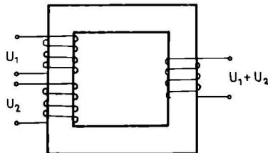
Addition mit Hilfe eines Transformators
