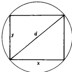
**Lösung:** Wegen  $x^2 + y^2 = d^2$  ist  $F = k(d^2x - x^3)$ . Die Funktion  $f(x) = d^2x - x^3$  nimmt ihr Maximum auf  $\{x | x \geq 0\}$  bei  $\bar{x} = \left(\frac{d^2}{3}\right)^{\frac{1}{2}}$  an, es ist  $\bar{x} = \frac{d}{3}\sqrt{3}$ , und an dieser Stelle nimmt  $F$
