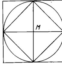
des ersten Quadrates. Durch jeden Eckpunkt zeichnen wir eine Gerade, die jeweils senkrecht zu einem bereits gezeichneten Durchmesser steht. Die Schnittpunkte dieser vier Geraden sind die Eckpunkte des zweiten Quadrates.
