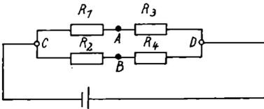
6. Wie groß ist die Spannung zwischen den Punkten A und B der Schaltung (vgl. die vorstehende Aufgabe), wenn bekannt ist, daß die Spannung an CD 10 V beträgt?
