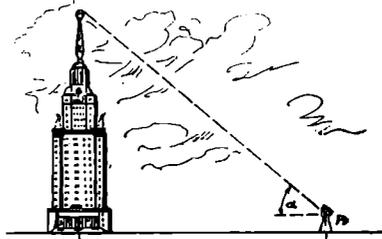
stimmt man mit einem Winkelmeßgerät aus der Entfernung  $a$  den Erhebungswinkel  $\alpha$  (Abb.). Berechne den Näherungswert der zu bestimmenden Höhe, wenn die Höhe des Meßgerätes  $h$  ist
