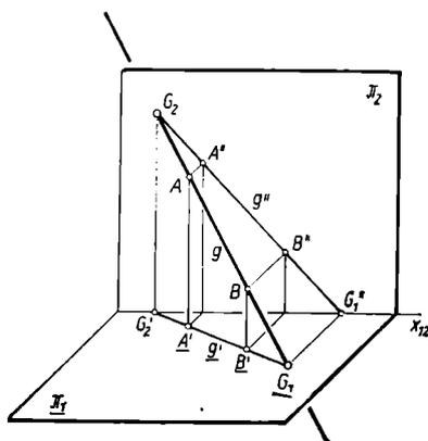
Bild 2 Darstellung der Bildebenen  $\pi_1$  und  $\pi_2$  sowie der Geraden  $g$  in einem Schrägriß
