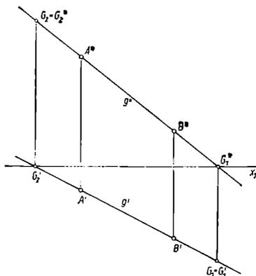
Bild 3 Darstellung der Geraden  $g = [AB]$  in zugeordneten Normalrissen
