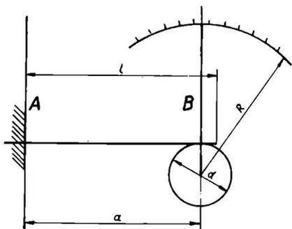
Wie lang ist der Kreisbogen, den die Spitze des Zeigers infolge der durch die Ausdehnung des Stahlstückes hervorgerufenen Drehung der Rolle auf einer Seite zurücklegt?
