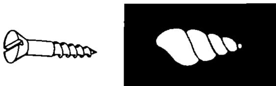
Holzschrauben, Metallschrauben und -spindeln haben fast immer Rechtsgewinde. Wenn du das betrachtest, erkennst du, warum man bei Rechtsdrehung etwas hineindreht oder schließt.
