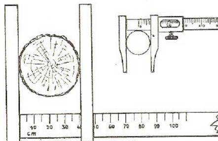
Abb. 20 Messkluppe und Messschieber
