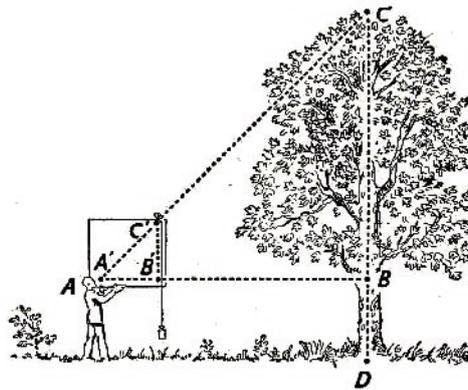
Abb. 5 Die Höhe eines Baumes wird mit dem Stecknadelgerät gemessen
