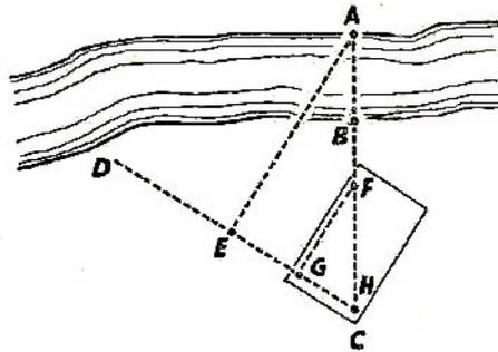
Abb. 31 Mit dem rechtwinkligen Dreieck mit einem Winkel von  $30^\circ$  wird die Flussbreite bestimmt
