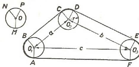
Abb. 132 Schematische Darstellung eines Antriebs. Wie wird die Länge eines Treibriemens bestimmt, wenn nur die hier angegebenen Maße benutzt werden?
