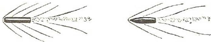
Abb. 49 Die durch ein fliegendes Geschoss erzeugten Luftwellen
