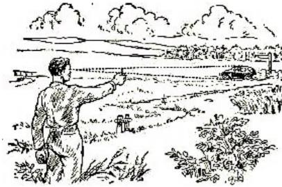
Abb. 38 Mit dem Streichholz werden unzugängliche Entfernungen bestimmt
