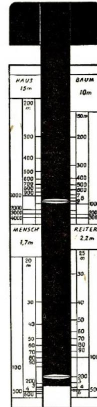
Abb. 40 Aufbau eines Entfernungsmessers mit einem Schieber
