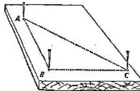
Abb. 4 Stecknadelgerät für Höhenmessungen
