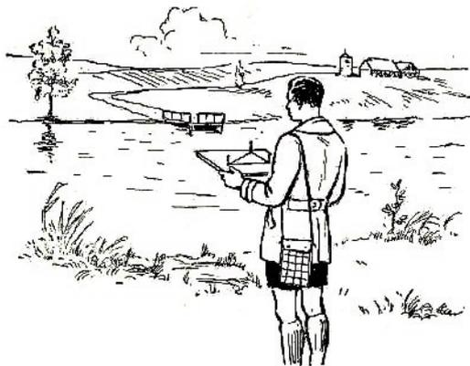
Abb. 25 Die Flussbreite wird mit dem Stecknadelgerät ermittelt
