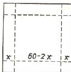
Abb. 173 Aus diesen Maßen muss die Umbiegekante bestimmt werden
