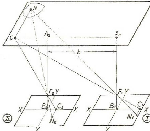
Abb. 75 Schematische Darstellung des Wolkenpunktes auf den Fotoplatten von zwei auf den Zenit gerichteten Fotoapparaten
