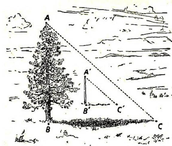
Abb. 1 Messen der Baumhöhe mit Hilfe der Schatten
