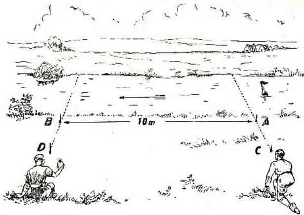
Abb. 41 Messung der Strömungsgeschwindigkeit
