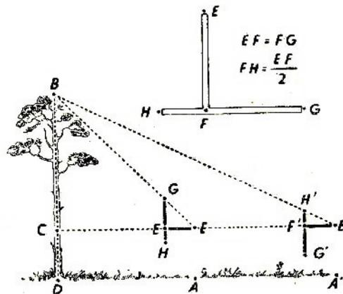
Abb. 10 Gebrauch des einfachen Höhenmessers aus zwei Leisten
