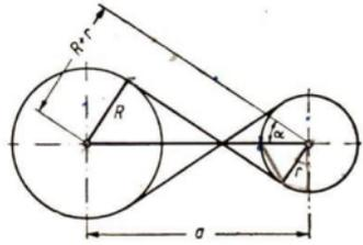
Abb. 31. Riementrieb mit gekreuztem Riemen
