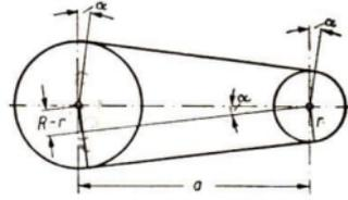
Abb. 30. Riementrieb mit offenem Riemen
