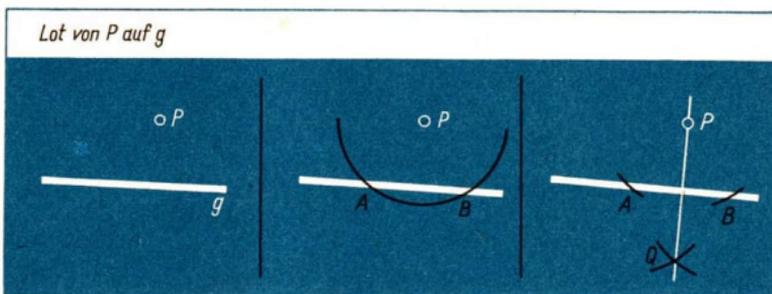
**Konstruktionsbeschreibung:** Wir zeichnen um  $P$  einen Kreis, der die Gerade  $g$  schneidet,  $A$  und  $B$  seien die Schnittpunkte des Kreises mit  $g$ . Um  $A$  und  $B$  zeichnen wir je einen Kreisbogen. Beide Radien müssen gleich lang und dabei größer als die halbe Strecke  $\overline{AB}$  sein. Beide Kreisbögen schneiden einander in  $Q$ . Die Gerade  $PQ$  ist das gesuchte Lot.
