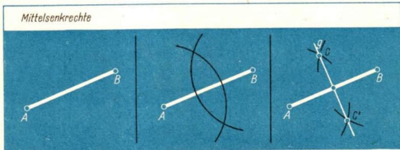
**Konstruktionsbeschreibung:** Wir zeichnen um die Endpunkte der Strecke  $\overline{AB}$  je einen Kreis mit gleichem Radius, der größer als die halbe Strecke sein muß. Die beiden Kreise schneiden einander in den Punkten  $C$  und  $C'$ . Die Gerade  $CC'$  ist die gesuchte Mittelsenkrechte.
