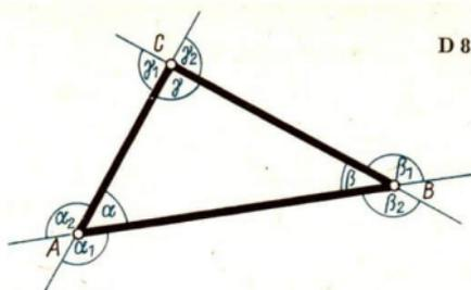
Zu jedem Innenwinkel gehören zwei Außenwinkel (Bild D 8), die als Scheitelwinkel kongruent sind. Wenn wir zu einem Innenwinkel *einen* zugehörigen Außenwinkel suchen, ist es gleichgültig, welchen Nebenwinkel des betreffenden Innenwinkels wir betrachten.
