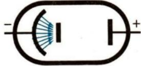
3. Elektronenstrahlen üben beim Aufprall eine Wärmewirkung aus. Die kinetische Energie wird in Wärmeenergie umgewandelt.
