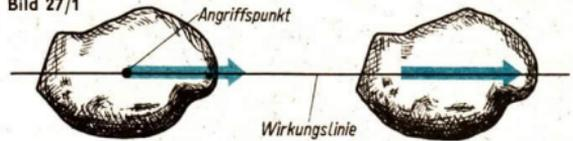
Wirkt eine Kraft auf einen **festen** Körper, der sich unter Kräfteinwirkung nicht verformt, so läßt sich noch eine **Wirkungslinie der Kraft** angeben. Längs dieser Wirkungslinie darf der Angriffspunkt der Kraft verschoben werden (Bild 27/1).
