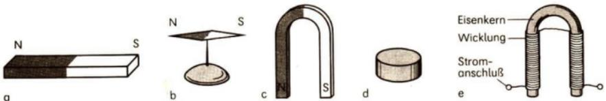
Bild 13/2 a) Stabmagnet b) Kompaßnadel c) Hufeisenmagnet d) Manipermagnet e) Elektromagnet
