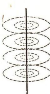
Abb. 201/2. Schematische Darstellung des Magnetfeldes eines stromdurchflossenen Leiters
