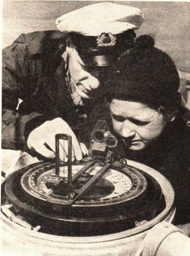
b) Windrose mit Stabmagneten. Der Kompaß wurde im volkseigenen Betrieb Geräte- und Regler-Werke Teltow hergestellt.
