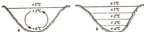
Abb. 25/1. Abkühlung eines stehenden Gewässers. a) Infolge der Abkühlung entsteht eine Strömung. b) Ist das Wasser auf mindestens 4 °C abgekühlt, so ergibt sich kein Kreislauf mehr, sondern eine Schichtung.
