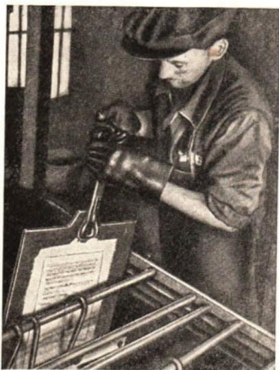
Abb. 126/3. Herausnahme einer galvanisch überzogenen Matrize aus dem Galvanisierungstrog
