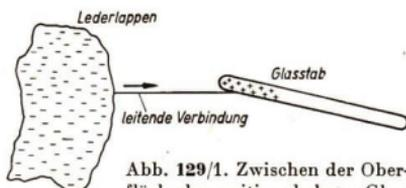
Abb. 129/1. Zwischen der Oberfläche des positiv geladenen Glasstabes und der des negativ geladenen Lederlappens herrscht ein Spannungszustand
