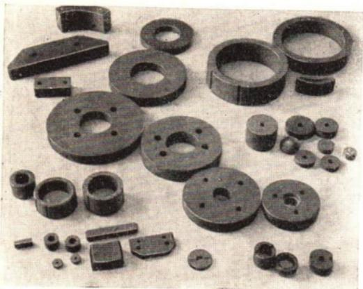
Abb. 192/1. Keramische Magnete unterschiedlicher Form
