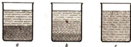
Abb. 6/2. Überschichtete Flüssigkeiten a) sofort nach Überschichtung b) nach wenigen Stunden c) nach mehreren Stunden
