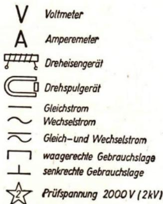
Abb. 218/2. Kennzeichen elektrischer Meßgeräte
