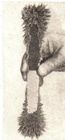
Abb. 195/3. Eisenfeilspäne an einem Stabmagneten
