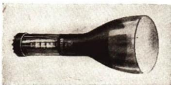
Abb. 148/2. Moderne Kathodenstrahloszillographenröhre
