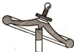
Abb. 207/1. Ein im Schwerpunkt unterstützter Kreisel
