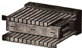
Abb. 85/3. Zungenfrequenzmesser. Schematische Wiedergabe seines Meßwerkes
