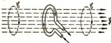
Abb. 38/1. Schematische Darstellung eines magnetischen Feldes und einer in ihm befindlichen Leiterschleife
