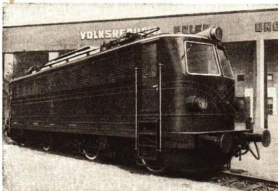
Es handelt sich dabei stets um Reihenschluß-Kollektormotoren. Zur Herabsetzung der Wirbelstrombildung hat man bei den Bahnversorgungsnetzen allgemein die Frequenz des Stromes auf  $16\frac{2}{3}$  Hz herabgesetzt.
