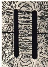
Abb. 114. Feldlinienbild eines Plattenkondensators
