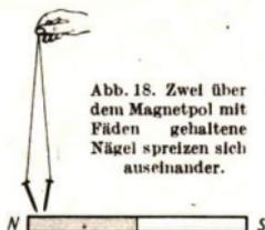
Abb. 18. Zwei über dem Magnetpol mit Fäden gehaltene Nägel spreizen sich auseinander.
