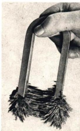
Abb. 6. Eisenfeilspäne, an einem Hufeisenmagneten hängend
