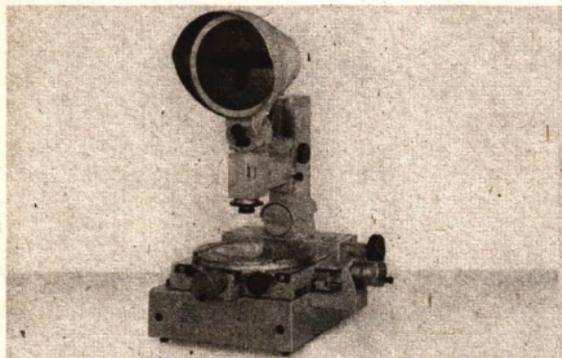
Optische Geräte, in denen die Gesetzmäßigkeiten der Lichtausbreitung zur Vergrößerung und Abbildung von Gegenständen angewendet werden, sind für Industrie und Landwirtschaft wie auch für die verschiedenen Zweige der Wissenschaft unentbehrlich. In diesen Geräten wird der Gang der Lichtstrahlen so gelenkt, daß z. B. Längen und Winkel gemessen und Formgenauigkeit und Oberflächengüte geprüft werden können.
