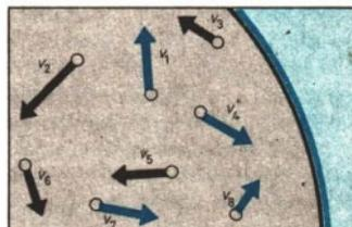
49/2 Ausschnitt aus Bild 49/1 als Modell eines Gases. Unregelmäßige Bewegung von Teilchen des idealen Gases mit unterschiedlichsten Geschwindigkeiten  $v_1, v_2, \dots, v_6$ .
