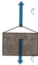
■ Eine Leuchte hängt an einem Seil (Bild 10/2), dessen beide Abschnitte mit der Vertikalen die gleichen Winkel  $\alpha_1 = \alpha_2 = 70^\circ$  einschließen.
