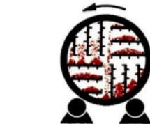
Abb. 62 Der Trommelmischer dient zum Mischen fester, pulverförmiger Stoffe
