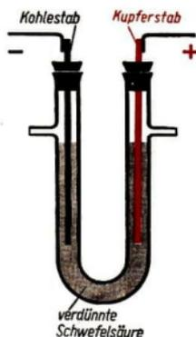
Abb. 75 Elektrolyse von Schwefelsäure unter Verwendung einer Kupferanode
