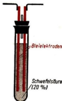
Abb. 73 Versuchsanordnung zur Wirkungsweise des Bleiakкумуляtors
