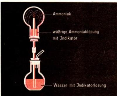
**Vorsicht, Implosionsgefahr!** Ein mit Ammoniak gefüllter Rundkolben wird mit einem Stehkolben verbunden, in dem sich Wasser befindet, dem einige Tropfen eines Indikators zugesetzt sind (Abb. 7). Einige Tropfen Wasser werden mit einem Handgebläse in den mit Ammoniak gefüllten Rundkolben gedrückt.
