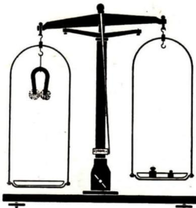
Abb. 15 Nachweis der Massenzunahme bei der Verbrennung
