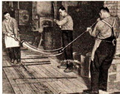
Abb. 39: Herstellen von Glasröhren im Handbetrieb.
