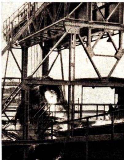
Abb. 96: Masselgießmaschine im Eisenhüttenkombinat Ost. In Kübelwagen wird das flüssige Roheisen vom Hochofen zur Masselgießmaschine gefahren und dort, wie die Abbildung zeigt, in Formen zu den sogenannten Masseln gegossen.
