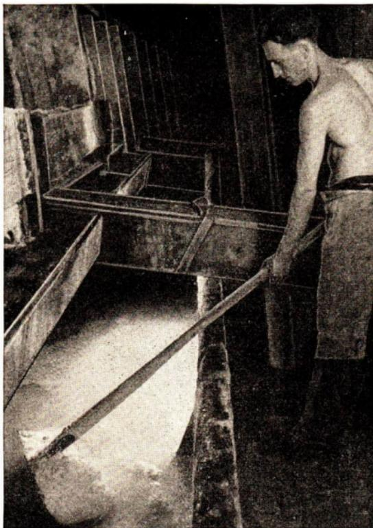
Abb. 57: Eindampfen der Sole: Das Salz wird „gekrückt“.
