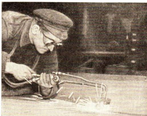
Abb. 30: Autogenes Schneiden einer Stahlplatte.
