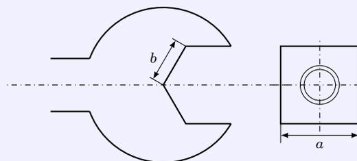
Eine Vierkantmutter (Kantenlänge 8) soll mit einem Sechskantschlüssel (Seitenlänge des Sechskants sei  $b$ ) gelöst werden.
