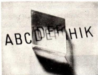
Abb. 276. Doppelbrechung im Kalkspat
