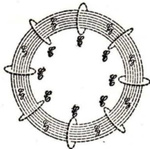
Abb. 92. Lage der elektrischen und magnetischen Feldlinien
