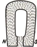
Abb. 64. Verlauf der Feldlinien im Hufeisenmagneten
