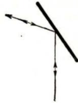
Abb. 282. Reflexion longitudinaler Wellen bei gedrehtem Spiegel
