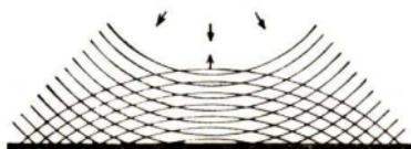
Abb. 237. Reflexion einer Kugelwelle
