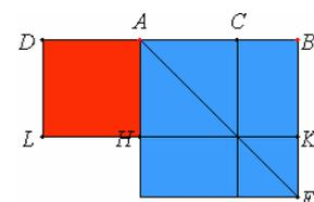
Die Strecke AB sei im Punkte C stetig geteilt, AC sei der größere Abschnitt und  $AD = AC$ . Ich behaupte, dass die Strecke DB in A stetig geteilt ist und größerer Abschnitt die Ausgangsstrecke AB.
