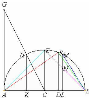
Man lege den Durchmesser AB der gegebenen Kugel hin, teile ihn in C so, dass  $AC = CB$ , und in D so, dass  $AD = 2 DB$ , zeichne über AB den Halbkreis AEB, errichte in C und D auf AB die Senkrechte CE, DF und ziehe AF, FB, EB.
