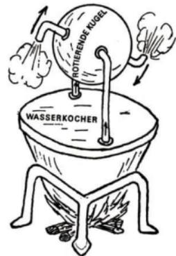
Heron's Dampfkreislauf, ein Vorläufer der Dampfmaschine
