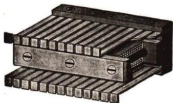
Abb. 85/3. Zungenfrequenzmesser. Schematische Wiedergabe seines Meßwerkes
