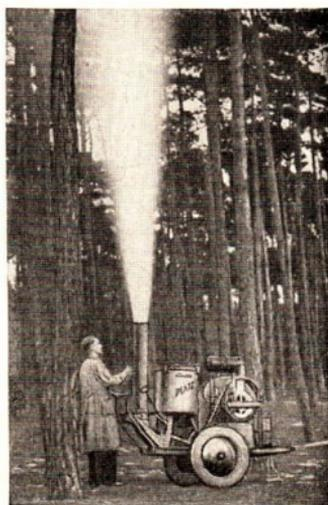
Abb. 281/3. Pulverzerstäuber mit IFA-Zweitaktmotor El 308
