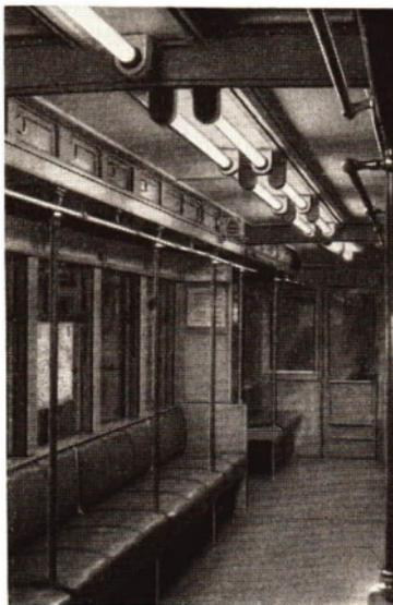
Abb. 127/1. Ein mit Leuchtstofflampen beleuchteter U-Bahn-Wagen
