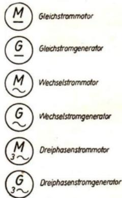
Abb. 50/3. Schaltkurzzeichen von Motoren und Generatoren
