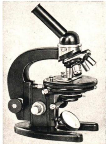
Abb. 71. Monokulares<sup>1</sup> Mikroskop mit gewinkeltem Tubus aus dem volkseigenen Carl-Zeiss-Werk in Jena
