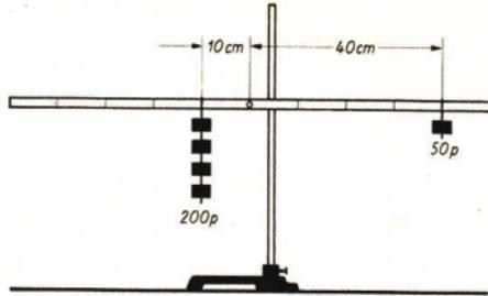
Abb. 129. Zweiseitiger Hebel
