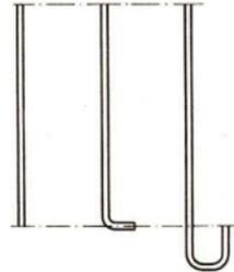
Abb. 103. Tauchröhrchen zum Prüfen und Vergleichen des Wasserdrucks
