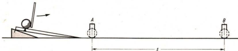
Abb. 178. Geschwindigkeitsmessung an einer auf einer waagerechten Bahn rollenden Kugel
