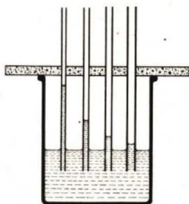
Abb. 192. Saugwirkung von Haar- und Kapillarröhrenchen mit verschiedenem Durchmesser. Die Haar- und Kapillarröhrenchen werden durch eine Korkscheibe gehalten.
