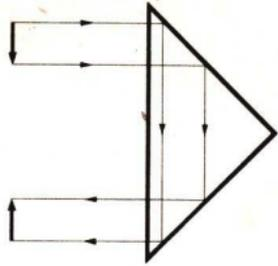
Abb. 75. Aufrichtung des Bildes durch ein Prisma
