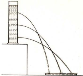
Abb. 99. Seitendruck des Wassers
