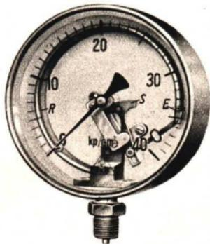
Abb. 114. Röhrenfeder-Manometer
