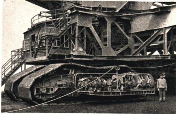
Abb. 93. Fahrgestell eines Schaufelradbaggers
