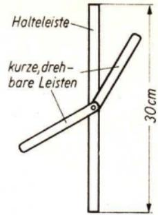
Abb. 31. Halteleiste mit zwei kurzen drehbaren Leisten
