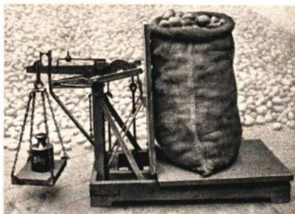
Abb. 145. Dezimalwaage im Gebrauch beim Abwägen eines Kartoffelsackes
