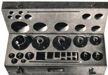
Abb. 139. Gewichtssatz. Seine Zusammensetzung entspricht dem angegebenen Beispiel.
