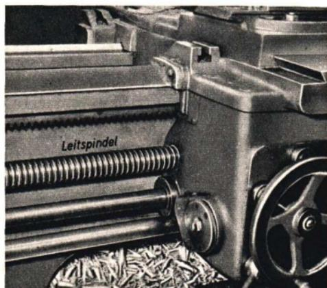
Abb. 176. Leitspindel einer Drehbank
