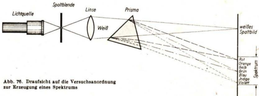
Abb. 76. Draufsicht auf die Versuchsanordnung zur Erzeugung eines Spektrums
