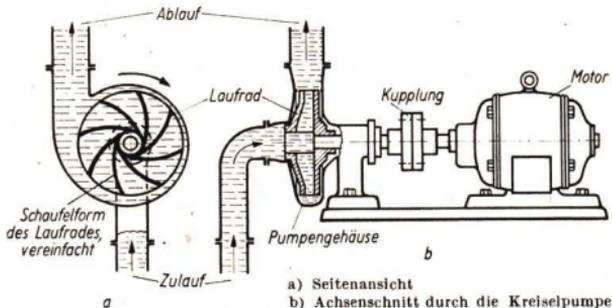
Abb. 183. Schematische Schnittzeichnung einer Kreiselpumpe
