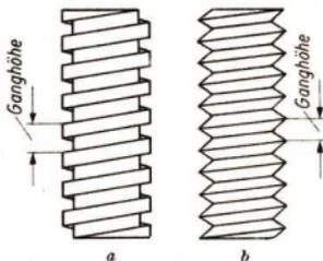
Abb. 173. Schraubenspindel
