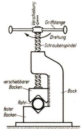
Abb. 171. Rohrschraubstock (Schraube übertrieben weitgängig gezeichnet)
