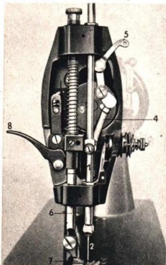
Abb. 190. Geöffneter Kopf einer Textima-Nähmaschine
