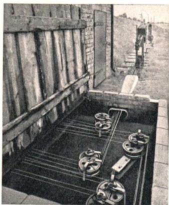
Abb. 148. Umlenkrollen im Rollenkasten eines Stellwerkes der Eisenbahn
