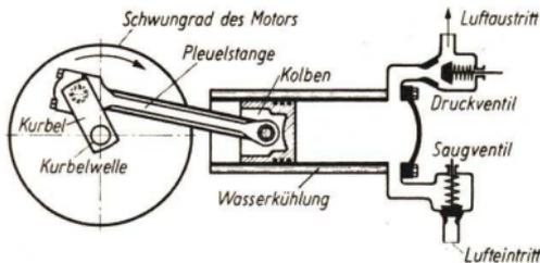
Abb. 111. Schnittzeichnung durch einen Kompressor
