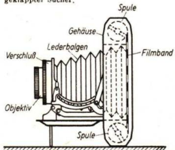
Abb. 54. Schnitt durch eine Rollfilm-Klappkamera (schematisch)
