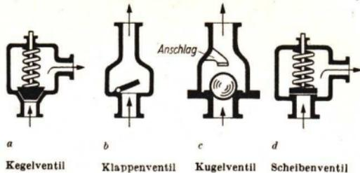
a Kegeltventil      b Klappenventil      c Kugelventil      d Scheibenventil
