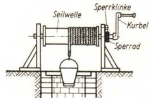
Abb. 160. Einfache Seilwinde im Gebrauch bei Kanalisationsarbeiten. Mit der Seilwinde werden aus dem Kanalschacht gefüllte Eimer emporgewunden.
