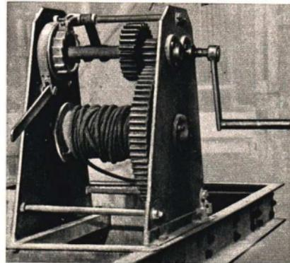
Abb. 163. Seilwinde mit Zahnradgetriebe
