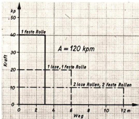
Abb. 196. Arbeitsdiagramm für Seilmaschinen
