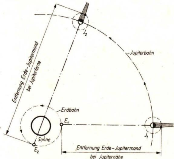
Abb. 9. Während der Jupiter von  $J_1$  nach  $J_2$  weiterückt, gelangt die Erde in der gleichen Zeit von  $E_1$  nach  $E_2$ . Sie entfernt sich dabei um die Länge des Erdbahndurchmessers vom Jupiter und seinem Monde.
