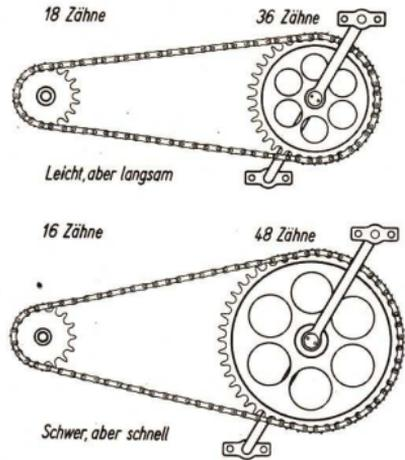
Abb. 186. Kettentrieb beim Fahrrad.
