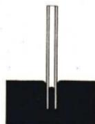
Abb. 193. Die Senkung des Quecksilberpiegels in einer Kapillarröhre
