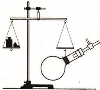
Abb. 115. Luft wird gewogen.
