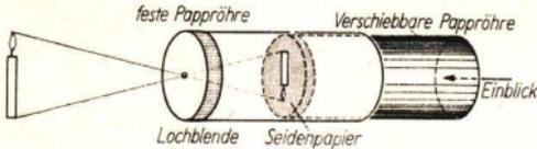
Abb. 8. Lochkamera (schematisch). Der von rechts hineinblickende Beschauer sieht auf dem Seidenpapierschirm das umgekehrte Bild der Kerze.
