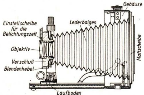
Abb. 51. Photographische Kamera. Plattenkamera älterer Bauart
