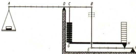
Der Hebel dreht sich um  $F$  und ist in 5 Teile unterteilt. Der kurze Arm des Waagebalkens und der einseitige Hebel sind außerdem durch eine durchbrochene Platte  $GH$  als *Brücke* verbunden. Sie hängt mit ihrem einen Ende  $G$  an der Stange  $CG$  und stützt sich mit dem anderen Endpunkt  $H$  auf den einseitigen Hebel in seinem ersten Teilpunkt.
