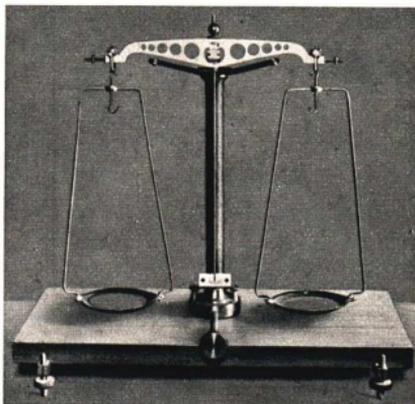
Abb. 140. Präzisionswaage für genaue Wägungen
