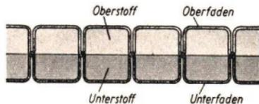
Abb. 191. Maschinennaht bei richtig eingestellter Fadenspannung
