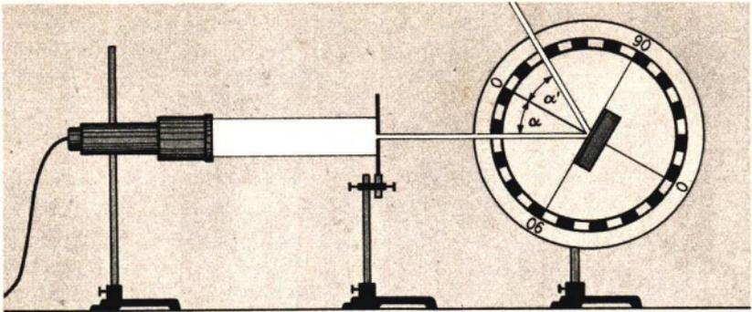
Abb. 12. Ableitung des Reflexionsgesetzes an der optischen Scheibe. Ein parallelstrahliges, schmales Lichtbündel tritt durch eine Spaltblende und streift über die optische Scheibe hin. Es trifft auf einen im Mittelpunkt der Scheibe befestigten Spiegelstreifen.
