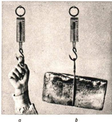
Abb. 84. Mit der Federwaage messen wir Kräfte.
