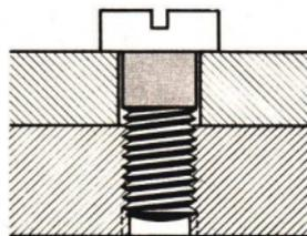
Abb. 175. Verbindung zweier Metallstücke durch eine Schraube
