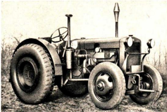
Der Brennstoff, in diesem Fall Rohöl, wird nicht vergast, sondern flüssig eingespritzt; er entzündet sich an der heißen Luft. Dieselmotoren haben infolgedessen keinen Vergaser und keine elektrische Zündung, sondern einen Kompressor und eine Einspritzpumpe.
