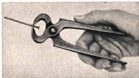
Abb. 132. Gebrauch einer Beißzange beim Durchkneifen eines Nagels
