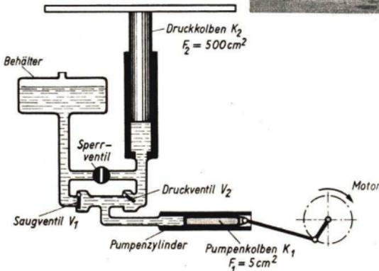
Abb. 96. Anlage eines hydraulischen Wagenhebers (Schema)
