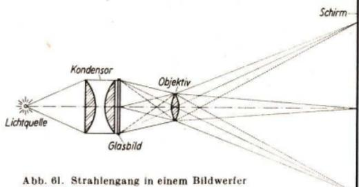
Abb. 61. Strahlengang in einem Bildwerfer für Glasbilder
