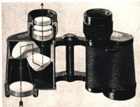
Abb. 74. Strahlengang im Prismenfernrohr (Carl Zeiss Jena VEB)
