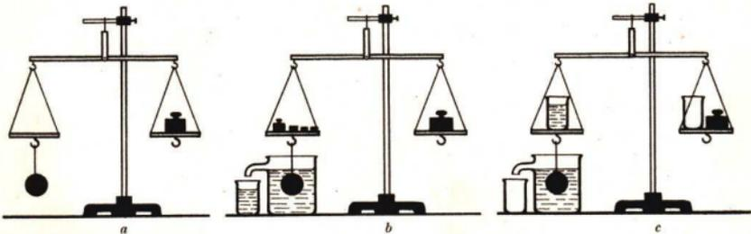
Abb. 105. Scheinbarer Gewichtsverlust einer Metallkugel im Wasser
