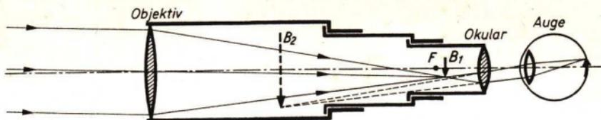
Abb. 73. Strahlengang im Keplerschen Fernrohr (schematisch). Die von einem Punkte am Rande des Sternes herkommenden parallelen Strahlen werden in einem Punkt vereinigt.  $B_1$  ist das umgekehrte, verkleinerte, reelle Bild des Sternes,  $B_2$  ist das durch das Okular gesehene, umgekehrte, virtuelle Bild. (Fernrohr und Auge sind nicht maßgetreu gezeichnet.)
