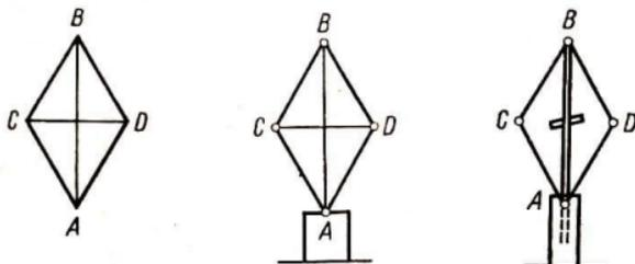
gelenkig. Wir fertigen das Untergestell aus einem Rohr (Zylinder) und schieben das eine Ende einer Stange hinein. Das andere Ende befestigen wir im Punkt  $B$ . Jetzt wird die Diagonale  $\overline{AB}$  immer eine senkrechte Lage einnehmen, natürlich wenn das Gestell senkrecht steht.
