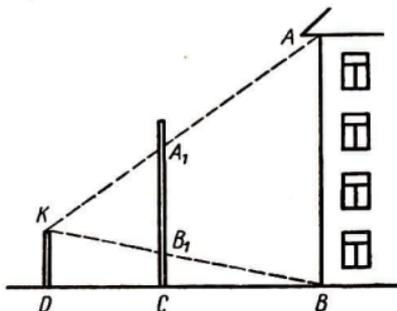
286. Die Höhe  $\overline{AB}$  eines Hauses, dessen Entfernung man messen kann, wird mit Hilfe zweier Fluchtstäbe bestimmt (Abb. 130). Welche Messungen werden dabei durchgeführt? Wie groß ist die Höhe  $\overline{AB}$  des Hauses?
