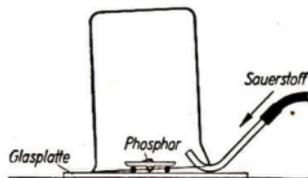
Abb. 46. Verbrennen von Phosphor in sauerstoffreicher Luft.
