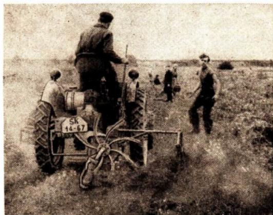
Abb. 21 Schleuderrädröder am Geräteträger (links) und Schema der Wirkungsweise des Schleuderrädröders (unten)
