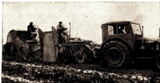
Abb. 32 Längsschwad-Köpfröder E 710 bei der Arbeit (oben) und Schema der Arbeitsweise (unten). Bewegungsrichtung auf beiden Bildern von links nach rechts. An der linken Seite der Maschine (im Schema oben rechts) werden von den Köpfelementen drei Reihen Rüben geköpft. An der rechten Seite der Maschine (im Schema unten links), schräg hinter den Köpfelementen, heben die Rodelemente drei Reihen Rüben aus dem Boden.
