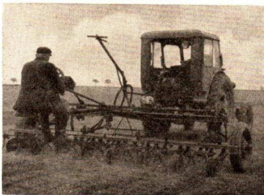
Abb. 30 Hackmaschine mit Schutzrollen beim Rübenhacken
