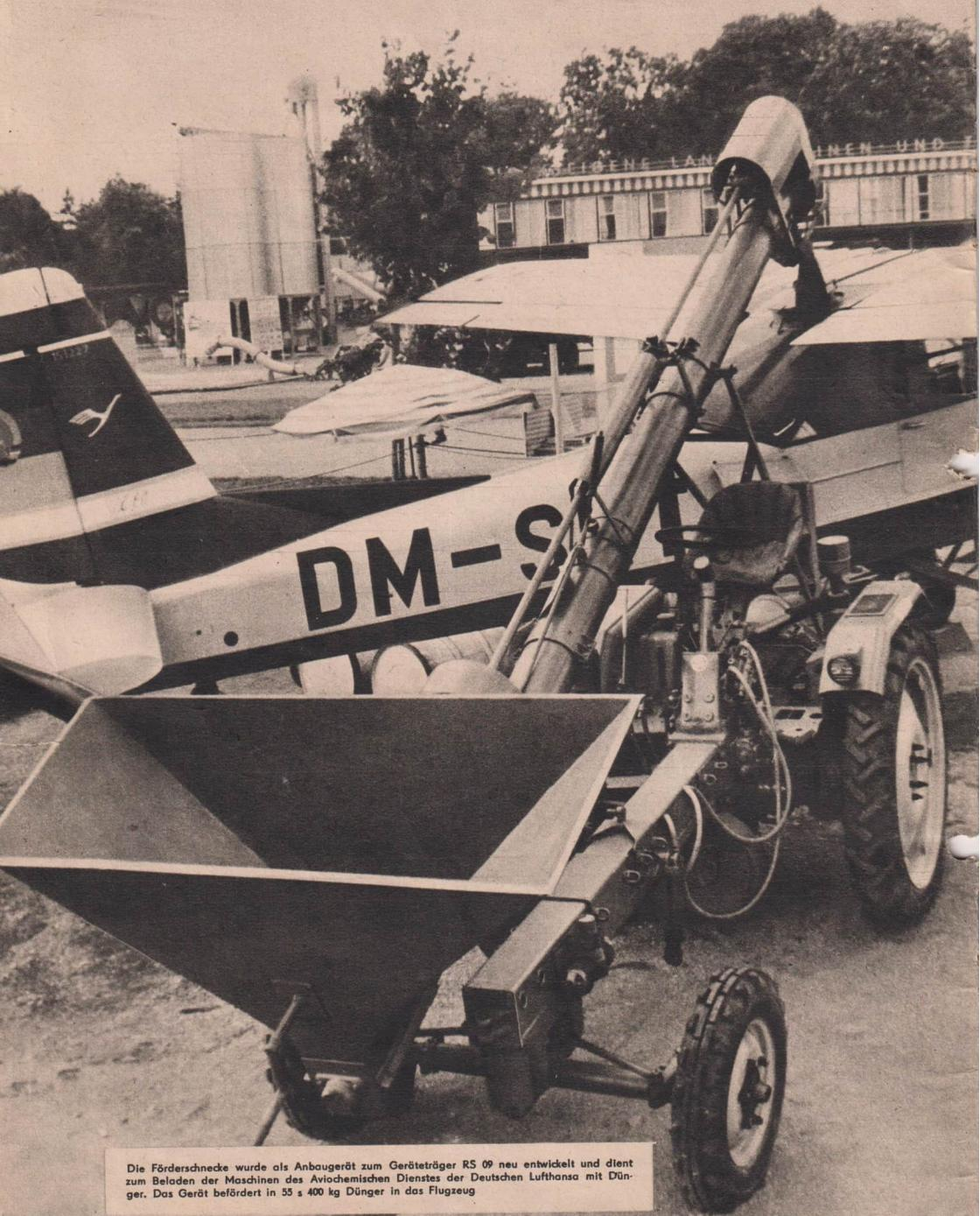
Die Förderschnecke wurde als Anbaugerät zum Geräteträger RS 09 neu entwickelt und dient zum Beladen der Maschinen des Aviochemischen Dienstes der Deutschen Lufthansa mit Dünger. Das Gerät befördert in 55 s 400 kg Dünger in das Flugzeug
