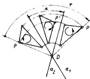
Bild 1d: Schubspiegelung
