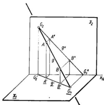
Bild 2 Darstellung der Bildebenen  $\pi_1$  und  $\pi_2$  sowie der Geraden  $g$  in einem Schrägriß
