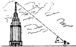
stimmt man mit einem Winkelmeßgerät aus der Entfernung  $a$  den Erhebungswinkel  $\alpha$  (Abb.). Berechne den Näherungswert der zu bestimmenden Höhe, wenn die Höhe des Meßgerätes  $h$  ist
