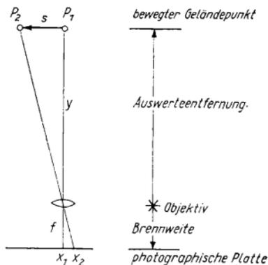
Prinzip der Geschwindigkeitsmessung an Gletschern
