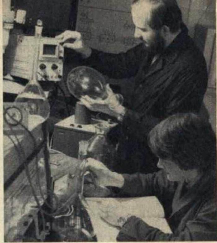
Neuentwickelte Geräte, wie dieses Wanddickenmeßgerät für Glashohlkörper, unterzieht man vor ihrer industriellen Verwendung einer Dauererprobung, um Angaben über mögliche Ausfälle zu gewinnen.
