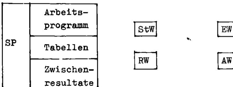
Der menschliche Rechner wird durch ein Steuerwerk (StW) ersetzt. An die Stelle der Tischrechenmaschine tritt das Rechenwerk (RW). Die zur logisch richtigen Abwicklung des Algorithmus erforderlichen Unterlagen (Arbeitsprogramm, Tabellen, Zwischenresultate usw.) werden in einer Baueinheit, dem Speicher (SP) aufbewahrt. Die Übernahme der Eingangsdaten in den Speicher erfolgt über ein Eingabewerk (EW). Die Auslieferung der Endresultate erfolgt über ein Ausgabewerk (AW).
