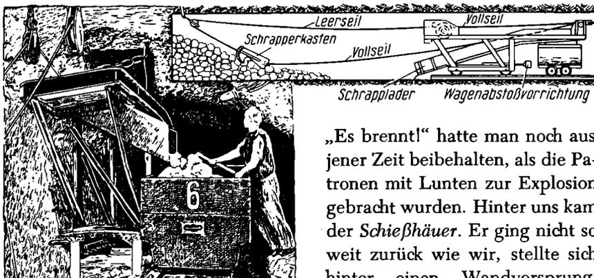
Schrappieranlage im Einsatz beim Streckenvortrieb und schematische Darstellung eines Schrappladers beim Streckenvortrieb
