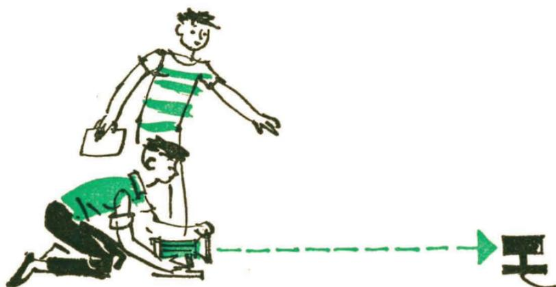
den Empfänger selbst wird eine Sammellinse gesetzt. Die Einrichtung wird mit sichtbarem Licht sorgfältig ausgerichtet. Die Folie oder der Farbstoffbehälter kommt direkt vor den Spiegel, nachdem Lichtquelle und Empfänger befestigt und gegen Verschiebung gesichert worden sind.
