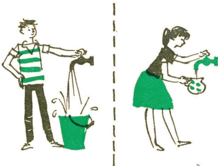
Widerstände kann man mit Ventilen oder Wasserhähnen vergleichen, die je nach Bedarf mehr oder weniger geschlossen werden.
