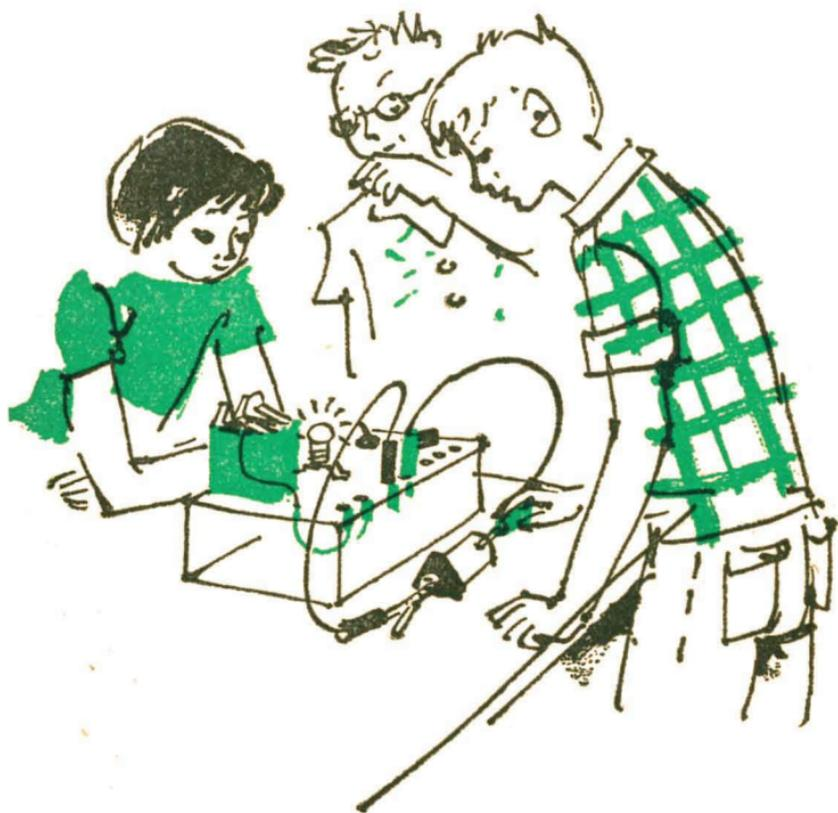
Kondensator an, so blitzt die Lampe wieder auf. Die Ladung, die im Kondensator gespeichert war, hat sich in Licht und Wärme umgewandelt.
