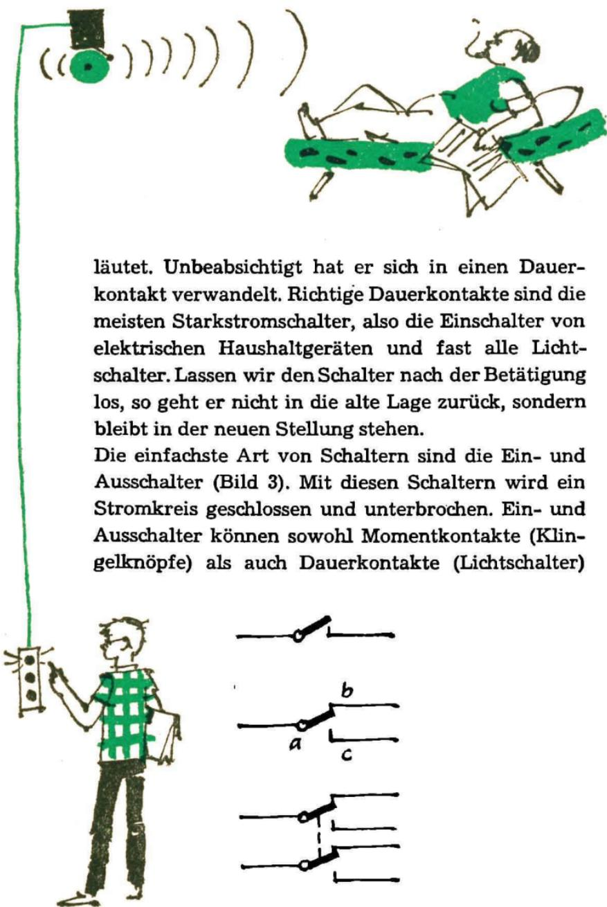
läutet. Unbeabsichtigt hat er sich in einen Dauerkontakt verwandelt. Richtige Dauerkontakte sind die meisten Starkstromschalter, also die Einschalter von elektrischen Haushaltgeräten und fast alle Lichtschalter. Lassen wir den Schalter nach der Betätigung los, so geht er nicht in die alte Lage zurück, sondern bleibt in der neuen Stellung stehen.
