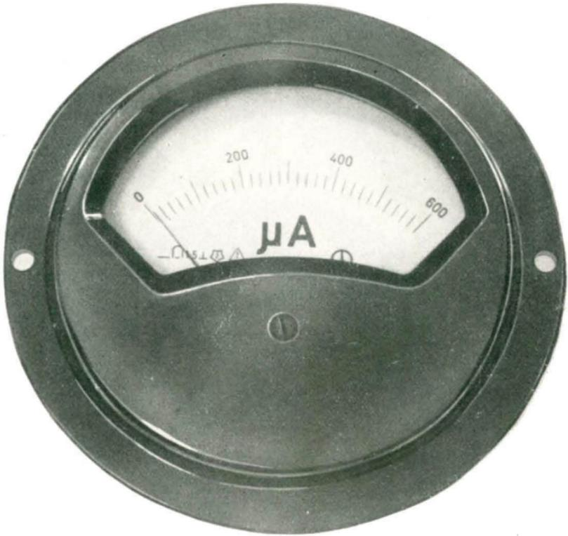
11 Strommesser mit einem Endausschlag von  $600 \mu\text{A}$  ( $=0,6 \text{ mA}$ )
