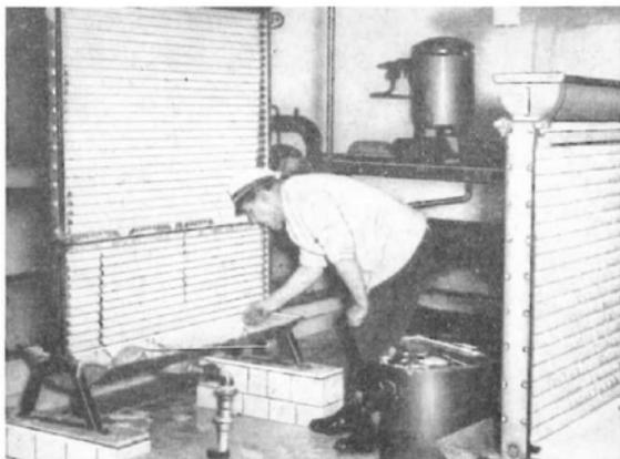
Jetzt wird der Rahm auf Butterungstemperatur heruntergekühlt und ins Butterfaß gebracht. Durch ein seitlich befindliches Schauglas kann man den Butterungsvorgang beobachten. Wenn die Butterteilchen Stecknadelkopfgöße haben, wird die Buttermilch abgelassen. Dann besorgt die Maschine das Reinigen und Kneten der Butterteilchen
