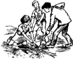
und stechen ihn in 12 bis 15 cm Entfernung von unserem vorbereiteten Profil, der Vorderwand unserer Grube, ein. Beim Herausnehmen des so entstandenen Bodenziegels helfen wir entweder mit der Hand oder mit unserem anderen Spaten nach, um die Probe nicht zu beschädigen.
