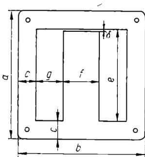
Bild 73. Einige standardisierte Mantelschnitte
