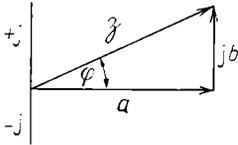
Bild 81. Betrag und Phasenwinkel einer komplexen Zahl
