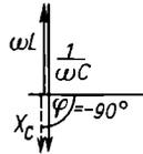
Bild 21 b. Widerstandsdiagramm bei überwiegend kapazitivem Widerstand
