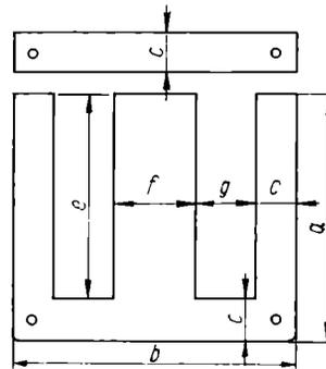
Bild 74. Einige standardisierte EI-Schnitte
