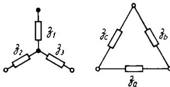
Bild 127. Sternschaltung und äquivalente Dreieckschaltung
