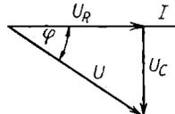
Bild 18b. Spannungsdiagramm
