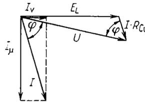
Bild 72. Zeigerdiagramm zu Bild 71
