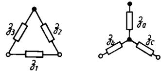
Bild 128. Dreieckschaltung und äquivalente Sternschaltung
