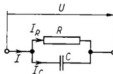
Bild 31. Parallelschaltung aus Wirk- und kapazitivem Widerstand
