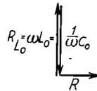
Bild 50 a. Widerstandsdiagramm des Reihenresonanzkreises
