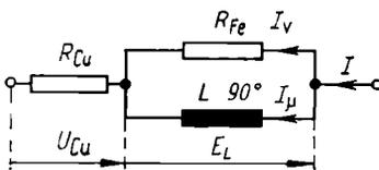
Bild 71. Ersatzschaltung der Drosselspule
