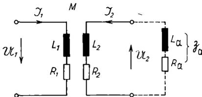
Bild 141. Ersatzschaltung des Transformators
