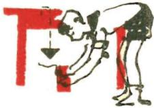
Dieses Gerät ist wesentlich empfindlicher als ein handelsübliches Dosenbarometer. Es genügt, die Flasche vom Tisch herab auf den Fußboden zu stellen, um eine deutliche Verschiebung des Tropfens wahrzunehmen. Bei heftigem Sturm oder Wind, ja sogar beim Zuschlagen der Tür zuckt der Tropfen und zeigt die plötzliche Luftdruckänderung an.
