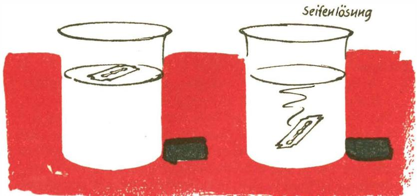
oberfläche von der Rasierklinge wie eine feine Haut „eingedrückt“ wird. Die Oberfläche ist „gespannt“.
