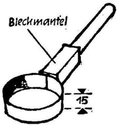
quadratisch, während der untere Teil auf 10 Millimeter Durchmesser gerundet wird. Der quadratische Teil muß dann mit einem 30 Millimeter tiefen Schlitz versehen werden, in den die Schenkel des aus Konservenblech gefertigten Ringes greifen.
