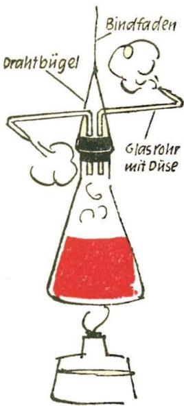
Die Bewegungsenergie des ausströmenden Dampfes hat unser Modell in drehende Bewegung versetzt. Dabei wurde es vom Dampf zurückgestoßen, denn das Modell bewegte sich entgegengesetzt zur Richtung des ausströmenden Dampfes.
