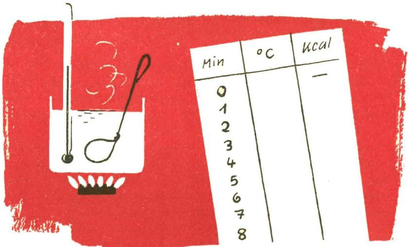
Mit einem aus starkem Draht gebogenen Rührer müssen wir nun ständig umrühren. Nach jeder vollen Minute wird die Temperatur abgelesen und eingetragen. Bei genauem Arbeiten können wir feststellen, daß die Temperatur in jeder Minute um die gleichen Werte zunimmt. Ungenauigkeiten am Anfang der Messung entstehen dadurch, daß der Aluminiumtopf zunächst selbst eine bestimmte Wärmemenge aufnimmt.
