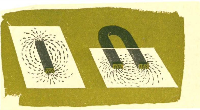
*Magnetische Feldlinien des Stab- und Hufeisenmagneten*
