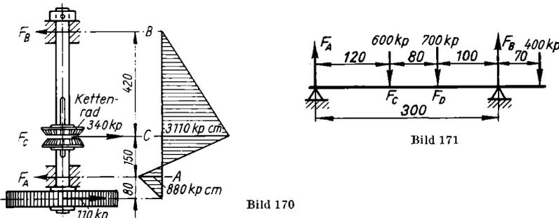
190. Die Momentenfläche und die Querkraftfläche des gegebenen Trägers auf zwei Stützen mit drei Einzellasten soll graphisch ermittelt werden (Bild 171).
