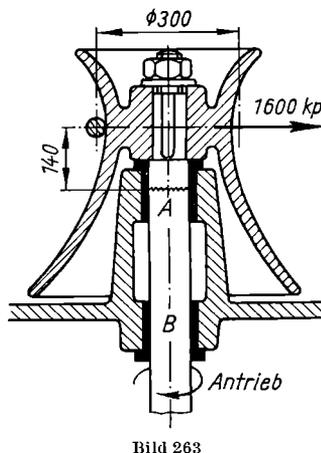
**292.** Eine Spilltrommel ist nach Bild 263 auf das vorstehende Ende einer senkrechten Welle aus St 50 aufgekeilt. Letztere, bei  $A$  und  $B$  gelagert, wird durch einen Elektromotor von unten her angetrieben. Ein Drahtseil wird mit einigen Windungen um die Trommel geschlungen und von ihr durch Reibung mitgenommen. Am ab-
