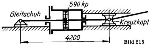
Stopfbuchsen nichttragend nachgiebig ausgeführt sind und das Kolbengewicht unberücksichtigt bleibt (Elastizitätsmodul  $2200000 \text{ kp/cm}^2$ ); **d)** die Durchbiegung der Stange infolge des Kolbengewichts (Einzellast in Mitte nach Aufg. 225); **e)** die gesamte Durchbiegung?
