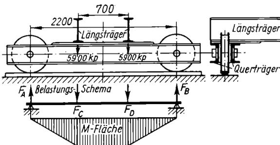
schnitt zwischen  $C$  und  $D$  wird durch dasselbe größte Biegemoment beansprucht, ist also ein „gefährdeter Querschnitt“.
