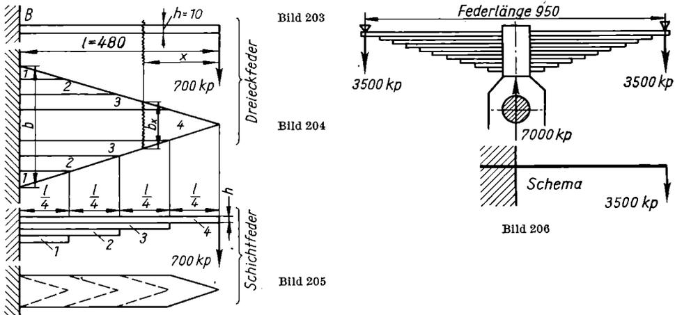
**220.** Wieviel Federblätter muß die in Bild 206 skizzierte 950 mm lange Schichtfeder einer Lokomotivachse bei einer Radlast von 7000 kp erhalten, wenn die Federblätter 90 mm breit und 13 mm dick sein sollen und die zulässige Biegespannung  $6500 \text{ kp/cm}^2$  betragen darf?
