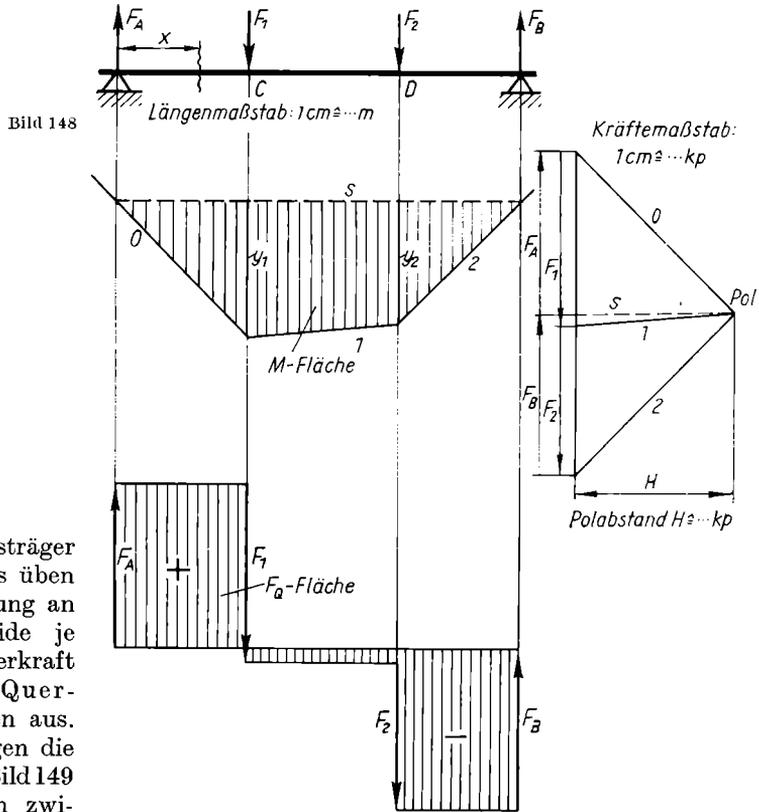
173. Die Längsträger eines Laufkrans üben bei Höchstbelastung an ihrem Ende beide je  $5900\text{ kp}$  Auflagerkraft auf die beiden Querträger zusammen aus. Letztere übertragen die Belastung nach Bild 149 durch die mittigen angeordneten Laufräder auf die Fahrseilen. Welche Profilnummer ist für die  $[-$ Stahl-Querträger bei einer zulässigen Biegespannung von  $600\text{ kp/cm}^2$  zu wählen?
