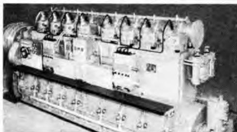
75/3 Großdieselmotor zum Antrieb von Schiffen und Schienenfahrzeugen
