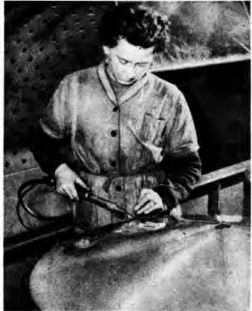
55/1 Schweißen eines Plastbehälters mit dem Heißluft-Schweißbrenner
