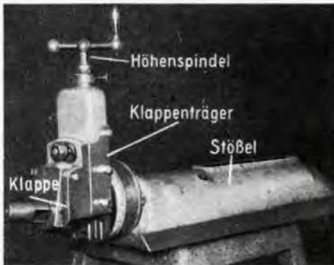
71/2 Stößel einer Waagrecht-Stoßmaschine
