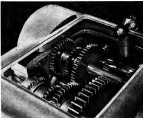
80/1 Spindelkasten einer Drehmaschine
