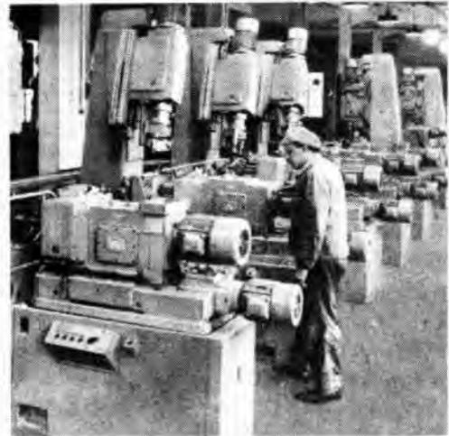
97/1 Automatische Fertigungsstraße aus Aufbaueinheiten
