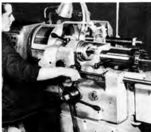
79/3 Bedienelemente einer Revolverdrehmaschine
