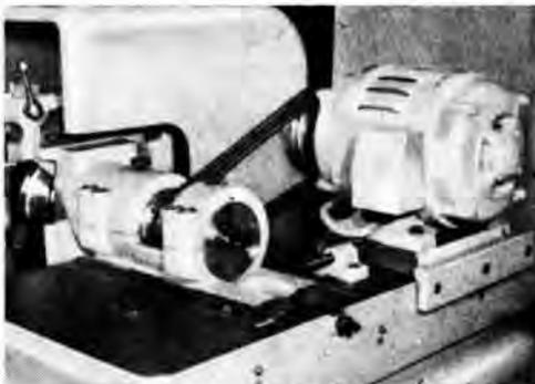
74/2 Einzelantrieb einer Werkzeugmaschine
