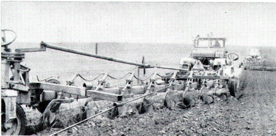
Bild 18/1 Sowjetischer Traktor K 700 mit Pflug B 501 (Arbeitsbreite 2,80 m)
