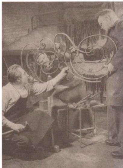
Bild 1 Einzelfertigung, Kunstschmied bei der Herstellung eines Gitters
