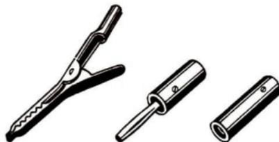
Bild 15 Krokodilklemme, Bananenstecker und Steckbuchse
