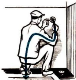
Bild 1 Der Strom fließt durch den Körper
