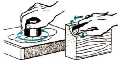
Bild 41 Schleifen kleiner Flächen
