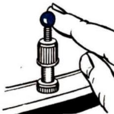
**Bild 5** Prüfen eines undichten Ventils
