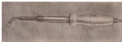
Bild 10 Elektrischer Lötcolben
