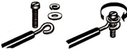
**Bild 5** Einsetzen der Schraube
