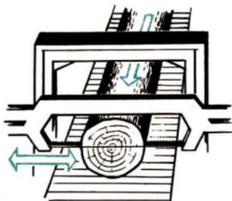
Bild 10 Waagrechtgatter – jedes Brett muß einzeln geschnitten werden
