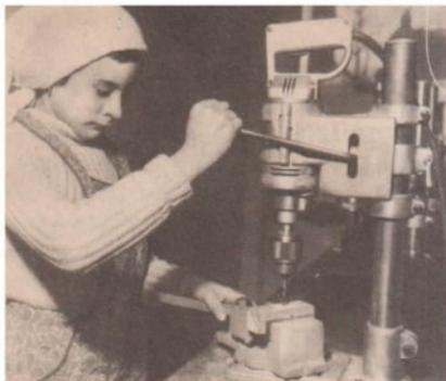
Bild 38 Bohren an der Tischbohrmaschine
