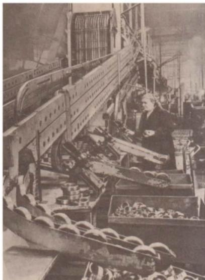
**Bild 3** Massenfertigung von Kugellagern
