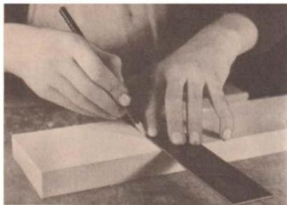
Bild 7 Das Anreißen mit dem Anschlagwinkel
