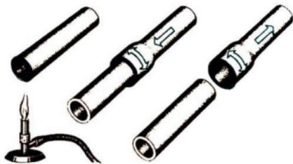
Bild 15 Anfertigen einer Rohrmuffe
