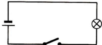
Bild 6 Schaltplan eines geöffneten Stromkreises
