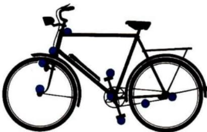
Bild 9 Schmierstellen am Fahrrad
