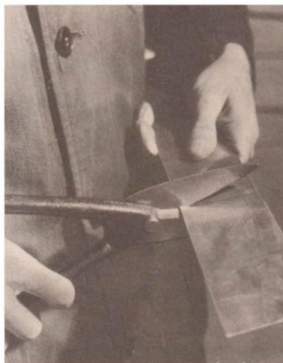
Bild 16 Scheren mit der Handblechscheren
