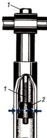
**Bild 8** Lenkerbefestigung
