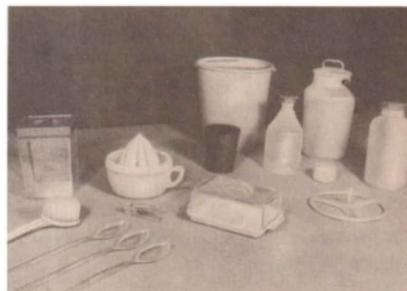
Bild 2 Gegenstände aus Polystyrol (links) und Polyäthyl (rechts)
