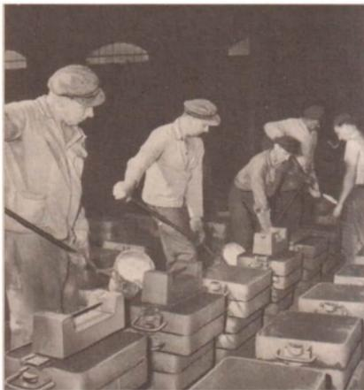
Bild 5 Gießen von flüssigem Grauguß in Sandformen
