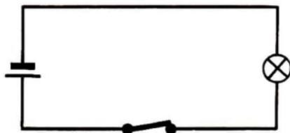
Bild 8 Schaltplan eines geschlossenen Stromkreises
