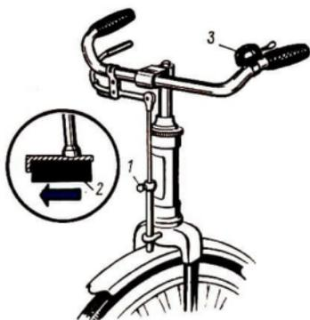
Bild 8 Handbremse und Fahrradglocke
