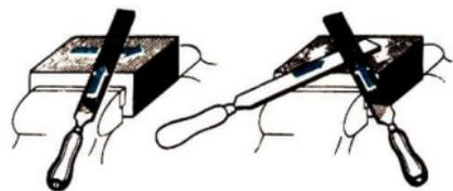
Bild 25 Längsstrichfeilen      Bild 26 Kreuzstrichfeilen
