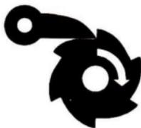
Bild 17 Sperrrad mit Sperrklinke verhindert das Zurückdrehen
