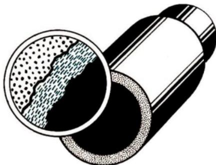
Bild 18 Ölschicht im Lager
