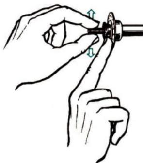
Bild 2 Lagerung der Vorderradnabe und Prüfen des Lagerspiels
