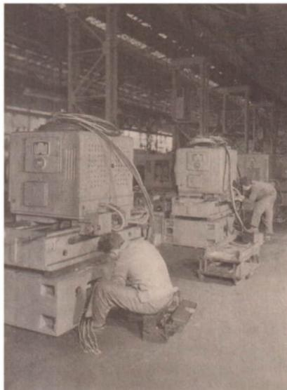
Bild 2 Serienfertigung von Bearbeitungsmaschinen für Taktstraßen
