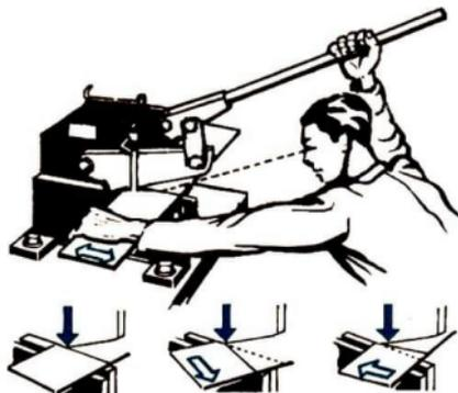
Bild 20 Scheren an der Handhebelschere
