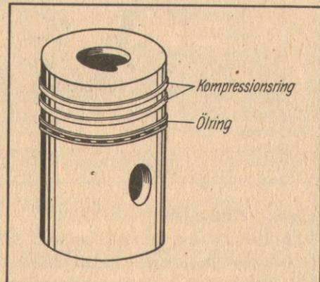
Bild 13/1 Kolben eines Dieselmotors mit Direkteinspritzung
