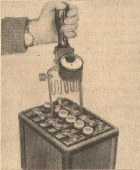
Bild 50/1 Prüfen der Zellenspannung an einem 12-V-Akkumulator
