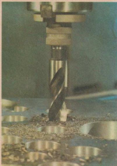
11/1 Arbeitsorgan einer Bohrmaschine mit Spanneinrichtung
